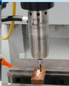
602JS 90,000 RPM 0.20HP / 0.15kW
