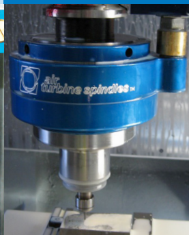
650CAT 40,000 RPM 1.4HP / 1kW
